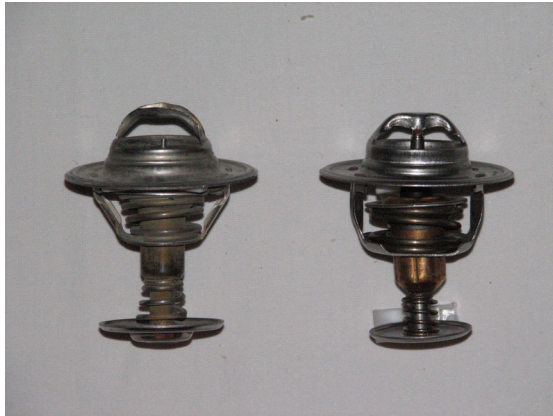
Abb. 9: Thermostate in ausgefahrenem Zustand bei 83°C respektive 88°C. (Zustand ist gestellt!)
