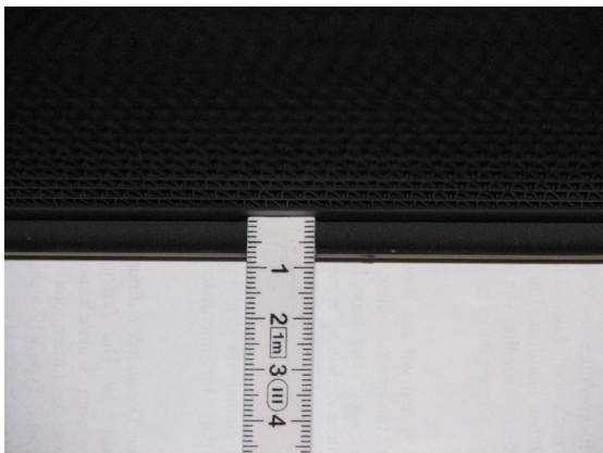
Abb. 5: Kühler des XJ-S V12 Pre HE mit originalen Kühlernetz. Man erkennt den Überstand des unteren Wasserkastens, der 7 mm beträgt. Da dieser Überstand auf der vorderen und der hinteren Kühlerseite vorhanden ist, besteht die Möglichkeit ein Netz mit ca. 15 mm größerer Tiefe einzusetzen.
