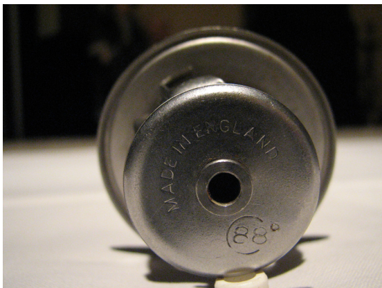
Abb. 7: Falsches Thermostat, da 88°C Spezifikation
